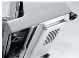
Motor racit cu aer protejat de capac metalic
